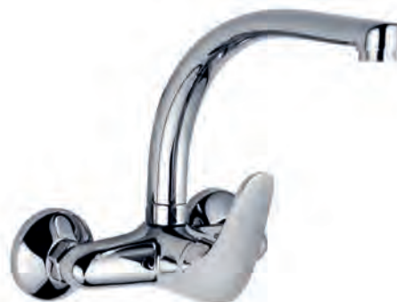
MONOCOMANDAMENT AIGÜERA PARET FICUS 9714414 Cos de llautó. Maneta metàl·lica. Cartutx Ø 40 mm, airejador M24, canella giratòria, certificació Sanitària ACS. Alt 16,5 cm (Distància entre l'eix de la maneta i la base de l'atomitzador).
