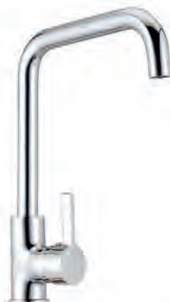
MONOCOMANDAMENT AIGÜERA CANELLA QUADRADA LIMA 9714413 Cos de llautó. Maneta metàl·lica. Cartutx Ø 35 mm, airejador H22 enrasat, canella giratòria, cable de xarxa 40 cm, marca Flexitub, amb certificat AENOR. Alt 33 cm. Certificació Sanitària ACS.
