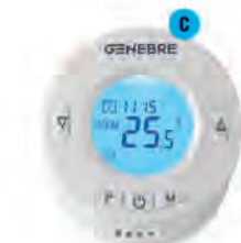
CAPÇAL TERMOSTÀTIC WIFI 9704540 Connexió de capçal a cos tipus universal M30 x 1,5. Pantalla LCD retroil·luminada per a una fàcil lectura. Fàcil d'instal·lar. Ús senzill amb només cinc botons. Programació de 24 hores per a 7 dies. La pantalla mostra temperatura actual o establerta i hora fixada. Indicació de temperatura en graus celsius. 50'95
