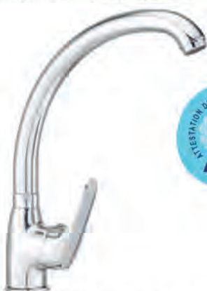
MONOCOMANDAMENT AIGÜERA SÈRIE FICUS 9714412 Cos de llautó. Maneta metàl·lica. Cartutx Ø 40 mm, airejador M24, canella giratòria, i rosca de fàcil fixació, cable de xarxa 40 cm, marca Flexitub, amb certificat AENOR. Alt 28,5 cm. certificació Sanitària ACS.
