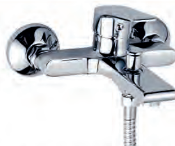
MONOCOMANDAMENT BANY-DUTXA 9714410 Cos de llautó. Maneta metàl·lica. Cartutx Ø 35 mm. Airejador M24 inclou mànec de dutxa anticalç i suport articulad, flexo inox amb doble plegatge i extensible 1.75-2.20cm. Certificació Sanitària ACS.
