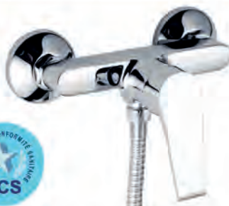
MONOCOMANDAMENT DUTXA 9714411 Cos de llautó. Maneta metàl·lica. Cartutx Ø 35 mm, inclou mànec de dutxa anticalç i suport articulad, flexo inox amb doble plegatge i extensible 1.75-2.20cm. Certificació Sanitària ACS.
