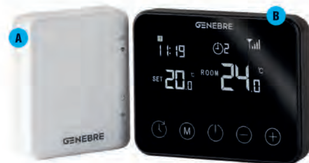
PACK WIFI GE-SMART 9704547 + Receptor WiFi "GE_SMART": Tensió de funcionament: 5V. Corrent de funcionament: 1A. Connector operatiu: Micro USB. Freqüència: 868MHz. Temperatura ambient: 5° C ~ 50° C. 78 mm x 98 mm x 28 mm. Color: Blanc. Grau de protecció IP: 30. 129'00
